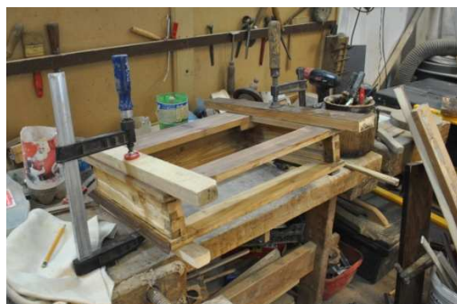
Fig.5 - Fixare cu prese metalice
