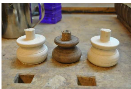
Fig.8 - Piciorușe noi și model original
